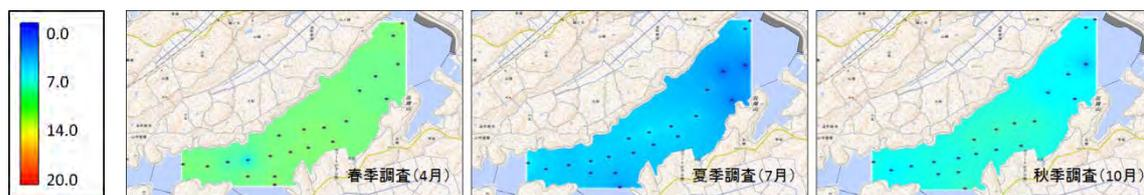
図2 長沼 DO 濃度断面分布 (mg/L)
