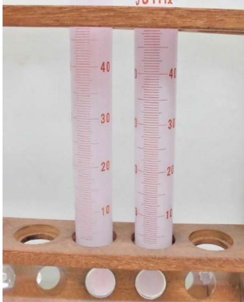
図2 カルシウム共存時にDPC吸光度法の試験操作過程で生じた白色沈殿 （左：カルシウム濃度5,000mg/L, 右：カルシウム濃度10,000mg/L）
