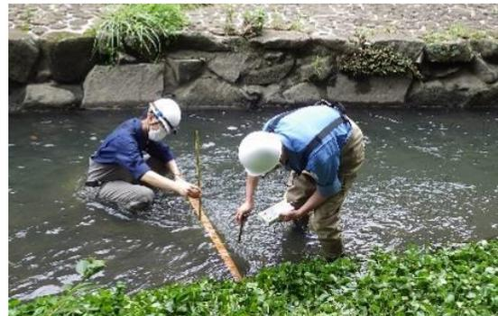
図5 横断方向の水深及び流速測定
