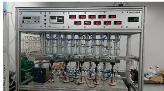
図7 トリチウム電解濃縮装置
