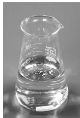
写真2 H 2 O 2 -Cu法による高分子吸収剤の分解
