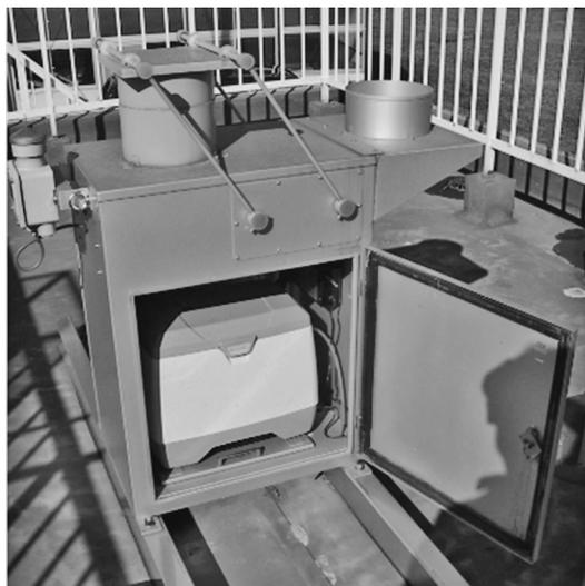
図4 降水時間開放型雨水採取器
