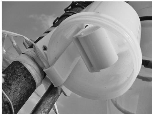
図3 O式パッシブ法(シェルター内にサンプラーが吊るしてある)
