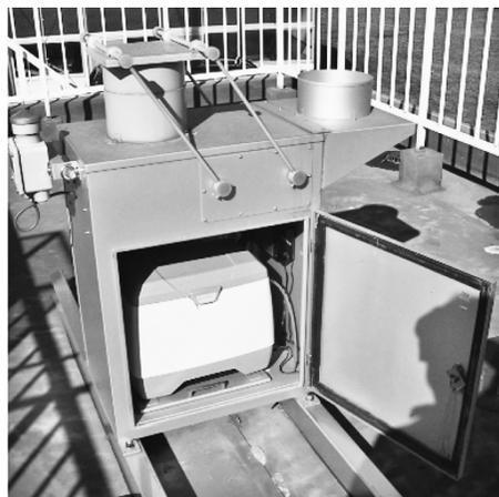
図2 降水時開放型雨水採取器
