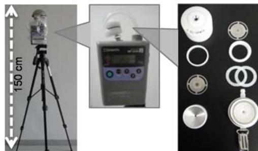
図1 PM2.5 サンプリング装置
