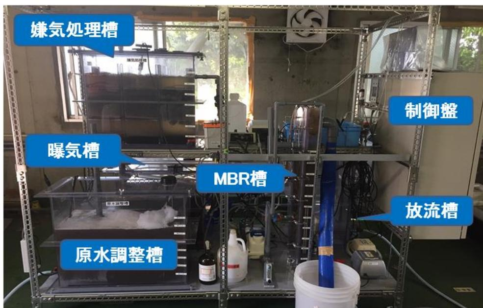
図6 実験装置を用いた総合排水の処理状況
